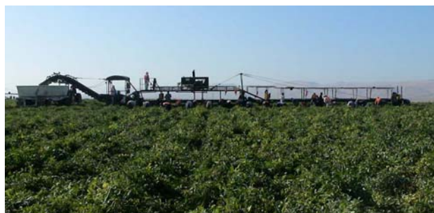
Figura 4. El sistema de banda transportadora móvil hace la cosecha a mano más eficiente. Credits: (S.A. Sargent)
