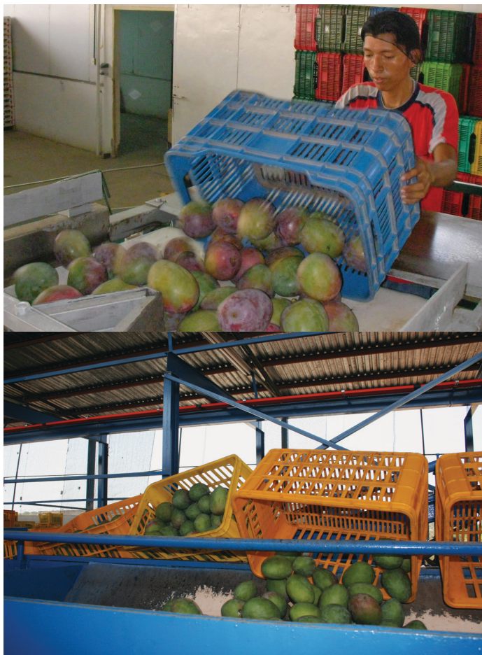
Descarga de frutos de mango en la línea de empaque: manual (foto superior) y automática (foto inferior)
