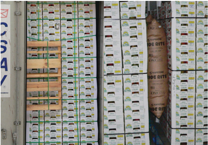
Uso de soportes de madera y bolsas de aire para estabilizar la carga en contenedores marítimos y tráilers (furgones)
