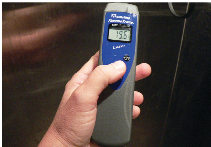
Medindo temperatura da superfície com um termômetro infravermelho
