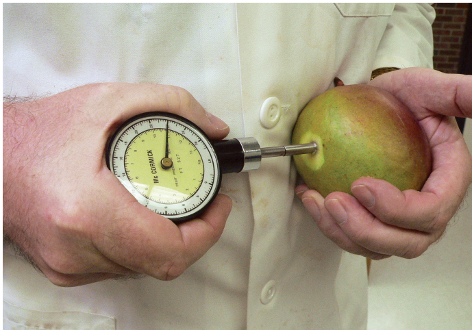
Medindo a firmeza da polpa da manga com um penetrômetro
