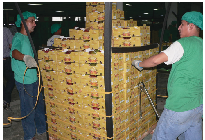
Cantoneira e fitas de arqueação sendo aplicadas a um palete
