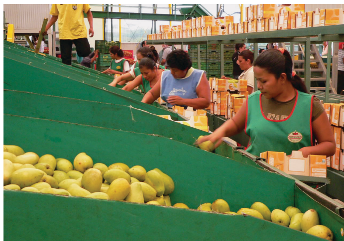
Classificação manual das frutas por tamanho e enchimento da caixa
