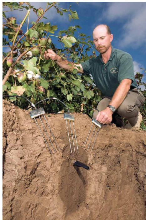
Figure 3. SDI colocado profundamente en un campo de algodón permite una larga vida útil y evita la interferencia con la labranza. El uso de sondas de monitoreo permite la medición del agua en el suelo. Créditos: Peggy Greb Credits: UF/IFAS
