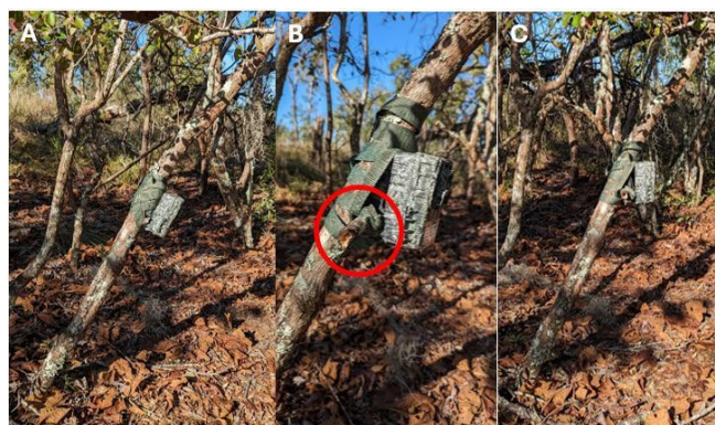
Figura 5. Una cámara trampa con un palo utilizado como “calza” para asegurar que el ángulo esté correcto. A) muestra la cámara desplegada en un árbol inclinado mirando hacia el suelo. B) muestra una vista ampliada del palo colocado detrás de la cámara para ajustar el ángulo. C) muestra la misma cámara después de colocar el palo, ahora con el ángulo correcto.
