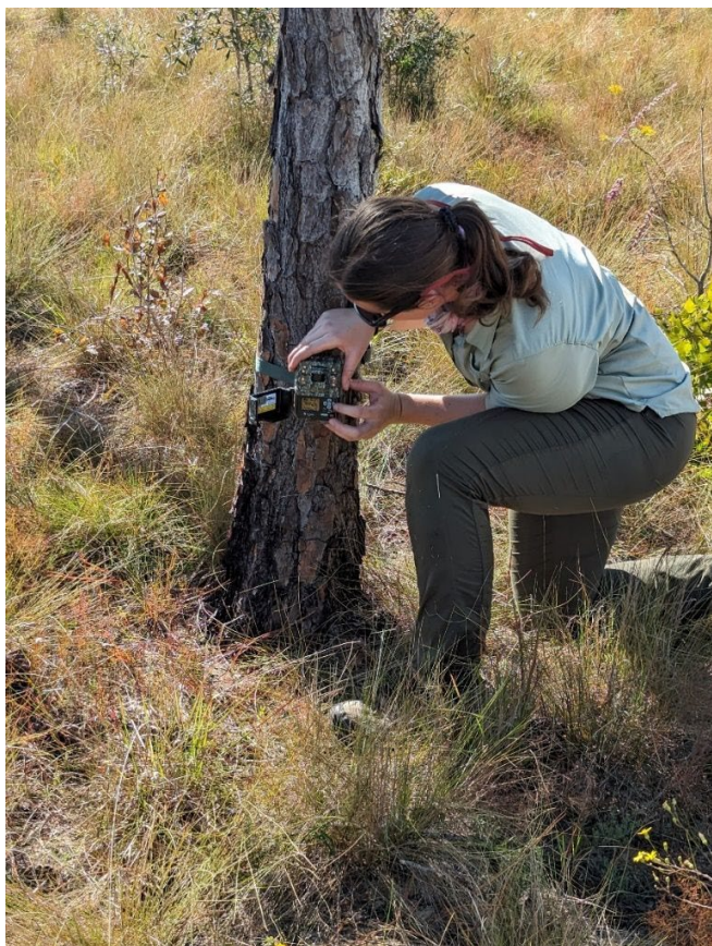
Figura 3. Ejemplo de colocación de una cámara trampa para la configuración estándar. Obsérvese que la cámara está en un árbol vertical y se coloca aproximadamente a la altura de la rodilla del técnico.
