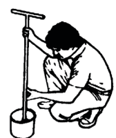
Figura 3. Coloque 5 a 10 muestras en una cubeta plástica; mezcle, seque y transfiera a una bolsa.
